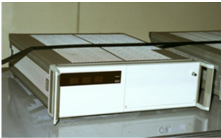
セシウム原子時計 (出所: 国立研究開発法人 情報通信研究機構)
