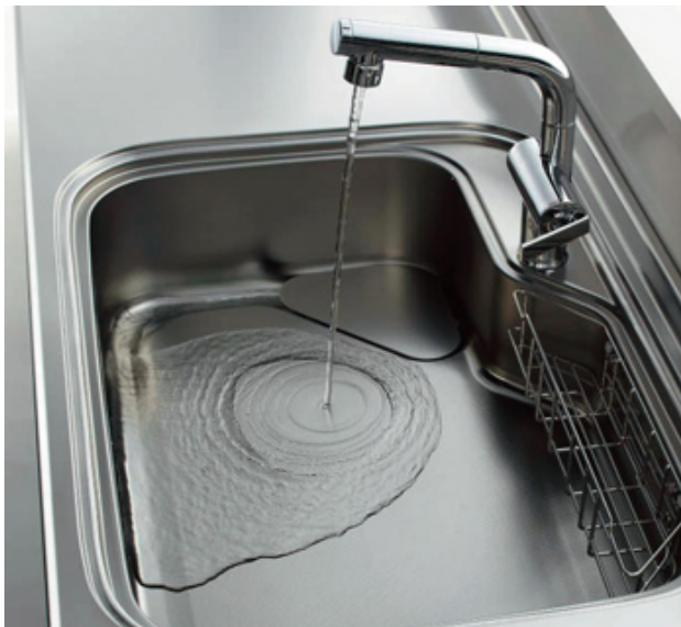
システムキッチン「クリンレディ」の新機能「流レールシンク」は、底部が奥から手前に傾斜しており、水の流れと傾斜の角度が一致。蛇口からの水の流れに沿って生ゴミがシンクの手前の溝を伝わり、奥の左隅にある排水口に流れるように全体形状を工夫した
