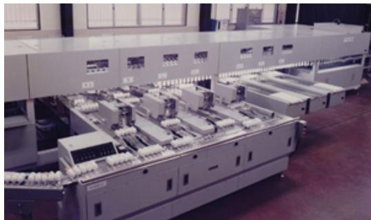
1979年、国内で初めて製品化した鶏卵全自動選別包装装置。鶏卵移送時の破損率を劇的に下げる、移送速度封殺制御技術を開発した
