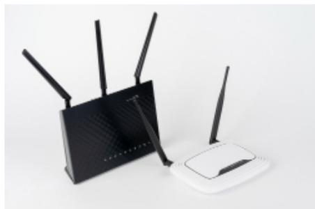
Wi-Fi中継機とは、Wi-Fiルーター(無線LANルーター、親機)から発信される電波を中継し、届く範囲を拡張するための機器です。
