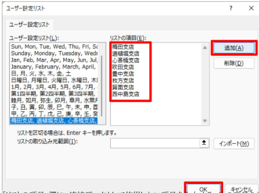
「リストの項目」欄に、連続データとして使用したい項目を入力する。次の項目を入力する前に「Enter」キーで改行。入力が終了したら「追加」を押してユーザー設定リストに追加する。「OK」をクリックし、オプション画面に戻ったら「OK」でエクセルの画面に戻る
